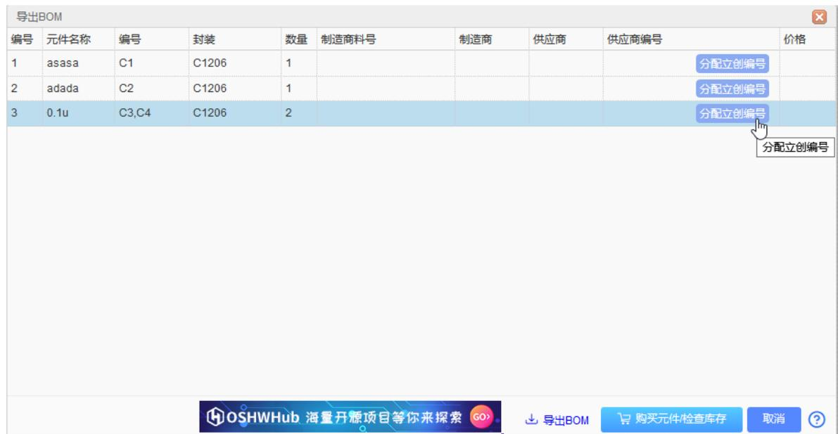
点击分配图标后会打开元件库搜索框，在这里找到你想要的零件后然后点击“分配”完成编号指定，分配的编号将出现在BOM中。
