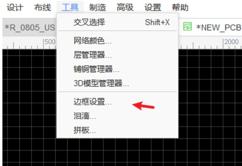
在对话框里你可以选择3中类型的边框：矩形，圆形，圆角矩形。并设置对应参数。
