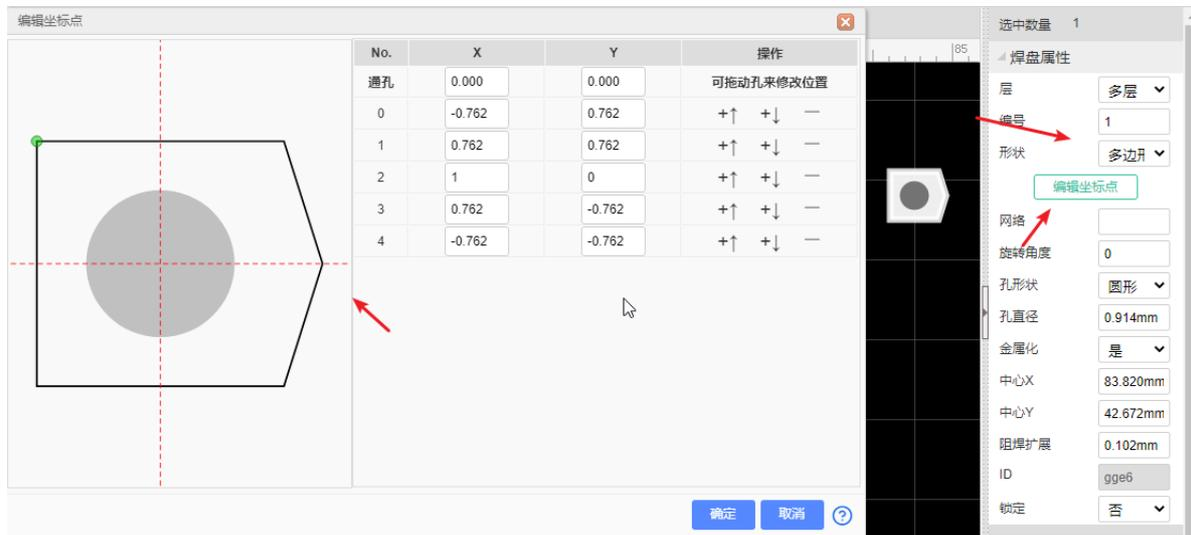
**层：**如果放置的焊盘是SMD类型或想它出现在单层，那么层请选择顶层或底层；若需要放置通孔类型焊盘，那么层请选择多层，焊盘将在顶层和底层出现，它会连接全部铜箔层包括内层。当是单层焊盘的时候不支持设置钻孔。
