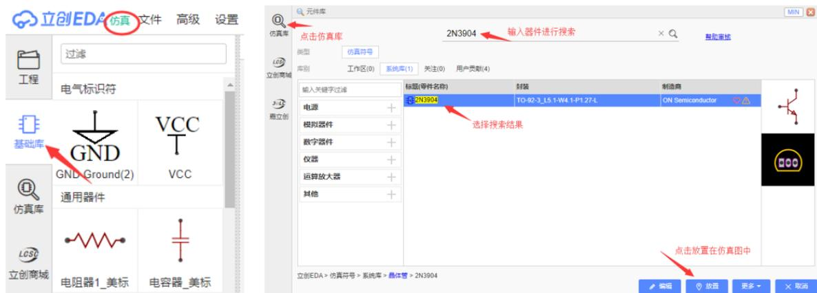
仿真实用库中包含常用的电源标识符、电阻、电容、电感、仪表、二极管、晶体管以及逻辑门等常规符号，部分仿真符号可以通过它们的下拉选择不同的样式（欧标、美标、3D），该器件参数值可以在图中直接双击修改文本名称即可。
