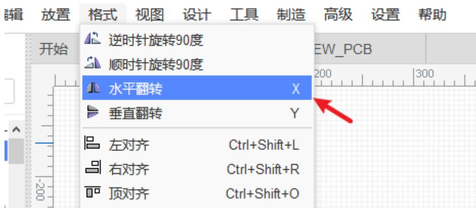
翻转与旋转放在一起，点击工具栏的旋转图标。
