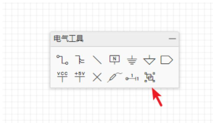
它与“符号库向导”相似，可以帮助你快速的创建符号库符号；也可以解散符号库符号，以便进行修改。
