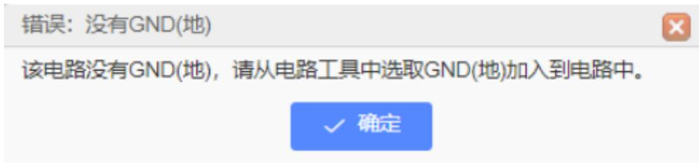
模拟仿真工作方式的一个特点是，它们必须在电路中的某处具有接地节点（也称为0电平）作为参考点进行工作。接地节点可以放置在电路中便于进行模拟测量，不能缺少。
