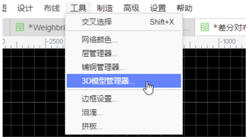
6、为对应的封装指定导入的 3D 模型，与封装管理器操作基本一致。具体使用教程请查看：[PCB - 3D 模型管理器](#)
