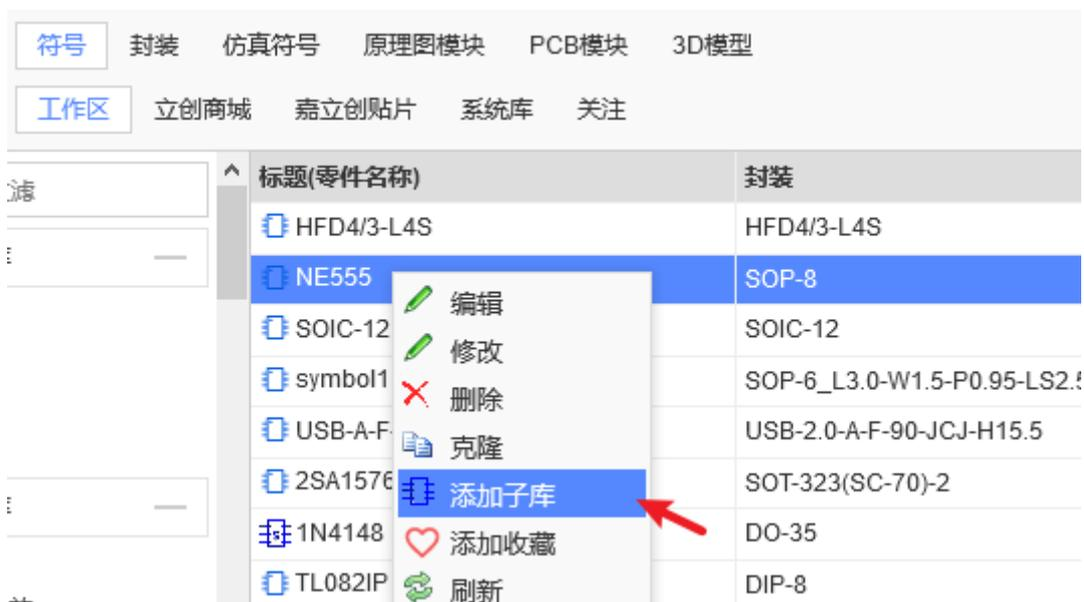
添加后并对每个子库进行双击或者点击下方的“编辑”按钮进行编辑图形，引脚及编号等属性，保存后即可完成一个含子库的符号库文件的创建。
