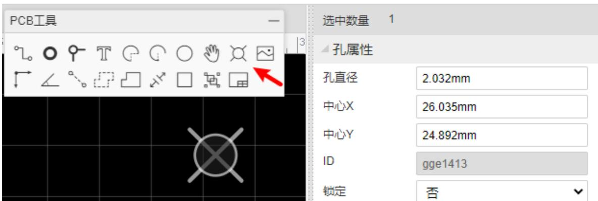
如果你想画槽孔，你可以使用实心填充(类型：槽孔(非金属化孔))，或者你绘制一条导线，然后右键它，选择“转为槽孔”菜单。
