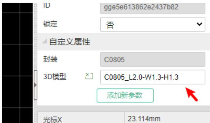
你打开3D模型管理器后可以为封装绑定3D模型，操作类似封装管理器。你可以自己导入或者搜索用户贡献的3D模型。导入教程请查看：[封装库 - 导入3D库](#)
