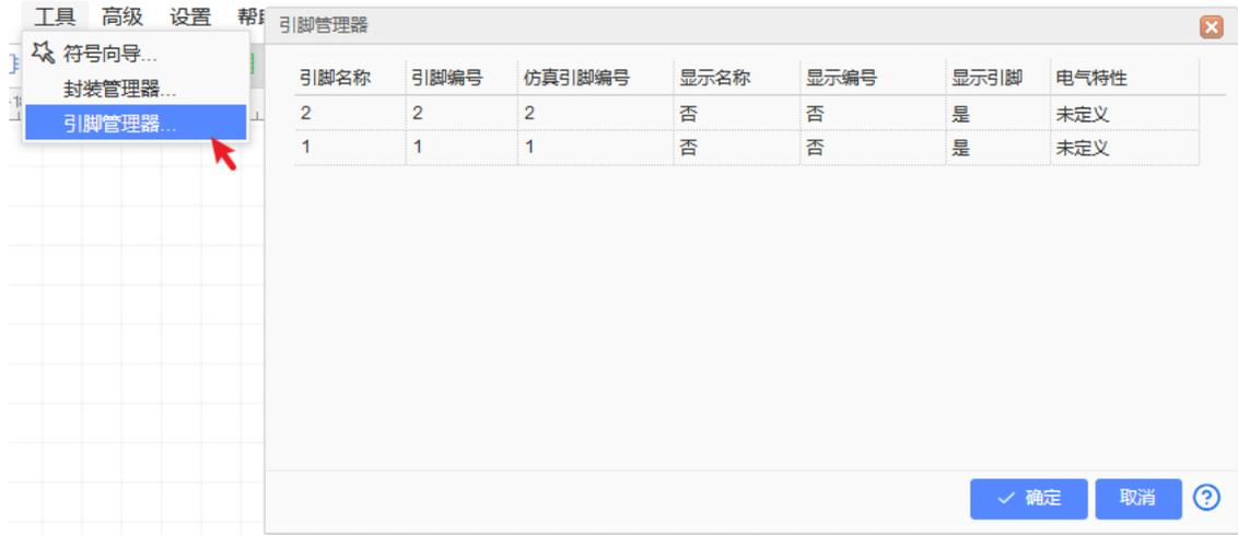
引脚编号必须和封装的焊盘编号一一对应，否则可能原理图无法正常转PCB。
