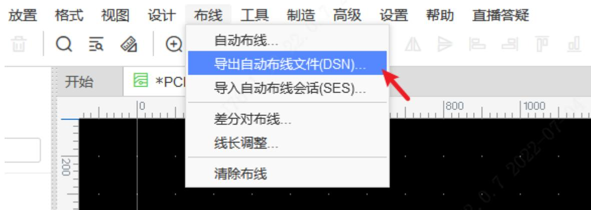
2、打开第三方自动布线工具，打开自动布线文件 DSN
