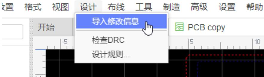
如果原理图存在错误，会直接弹窗提醒，如标注重复，封装缺失等。具体可以查看：[原理图 - 原理图转PCB](#)
