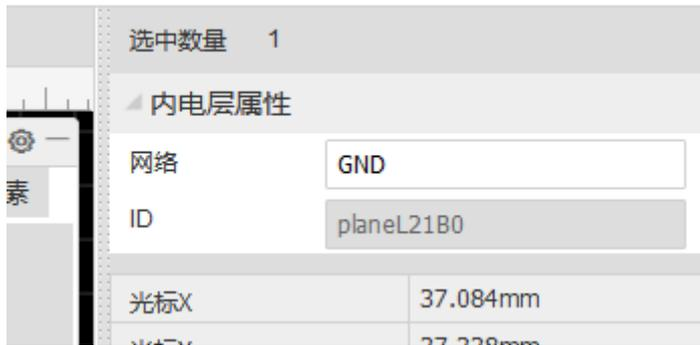
**注意**：在绘制内电层的导线时，导线的起点和端点必须超过边框线的中心线，否则内层区域无法被分割；使用内电层时，PCB不能有多个闭合边框，否则只会有一个闭合边框内部正常生成内电层。
